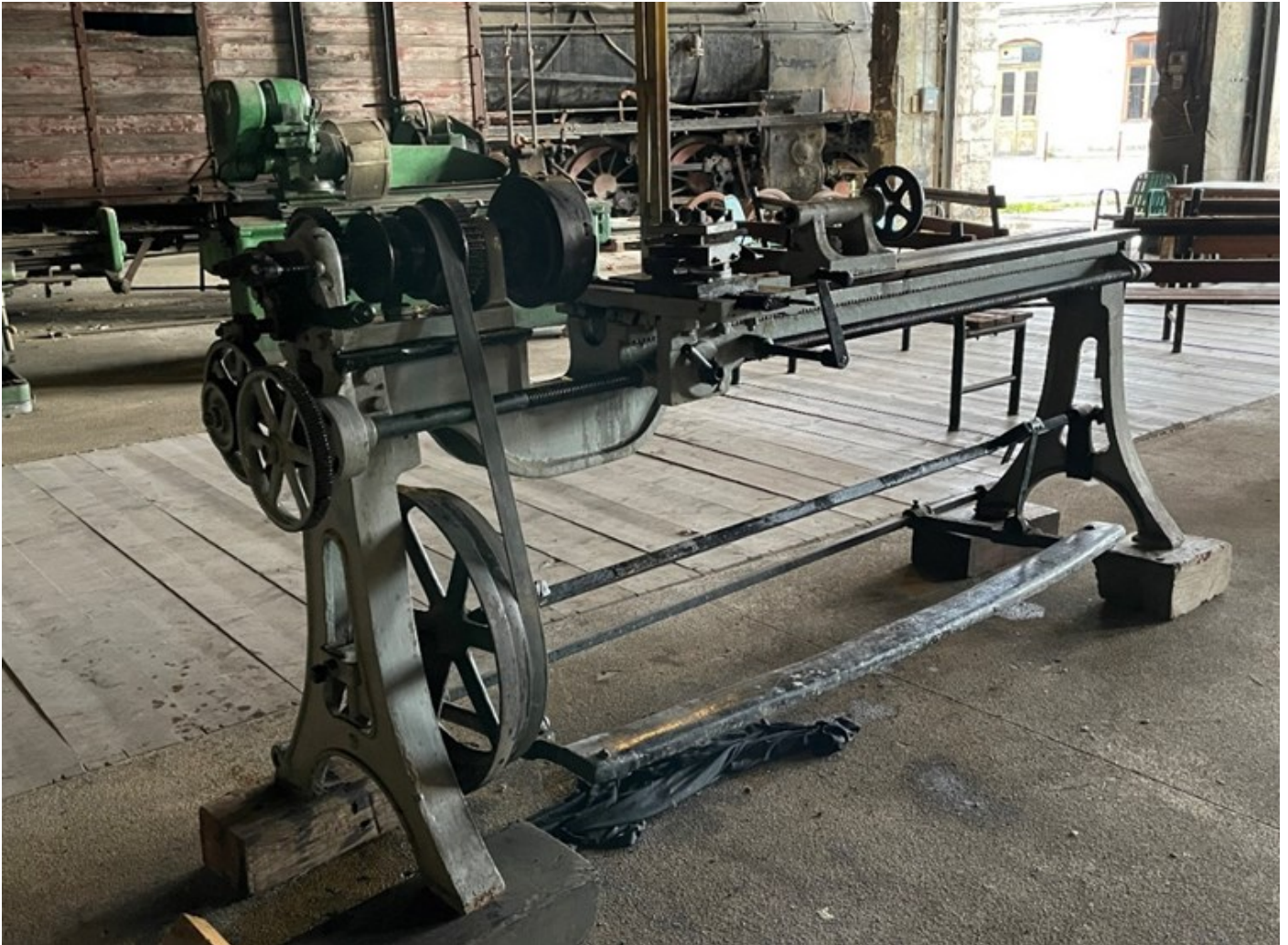
Ποδοκίνητος τórνος του ΣΠΚ, μετά τη συντήρηση και αποκατάσταση της λειτουργίας του.
